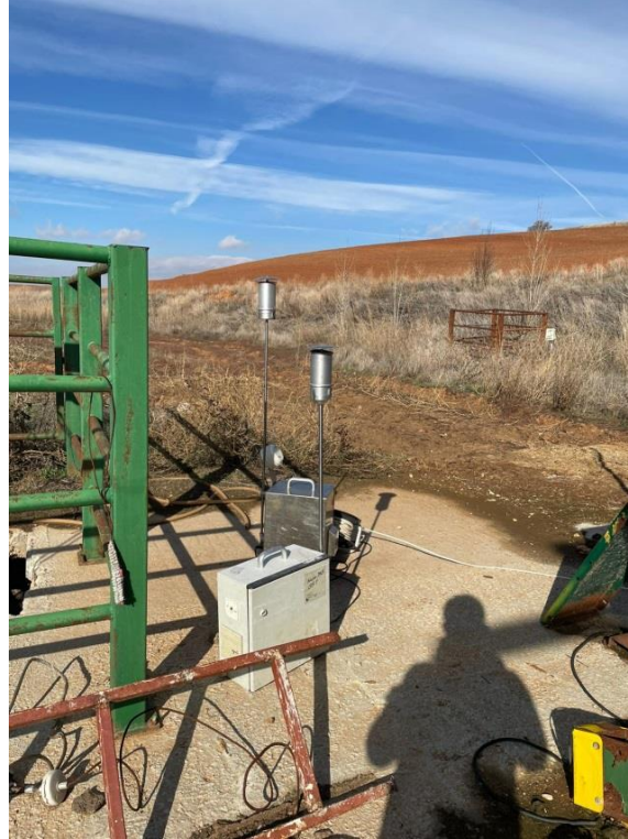
Şekil IV.19 Doğanhisar'da PM 10 ve PM 2.5 ölçümü
